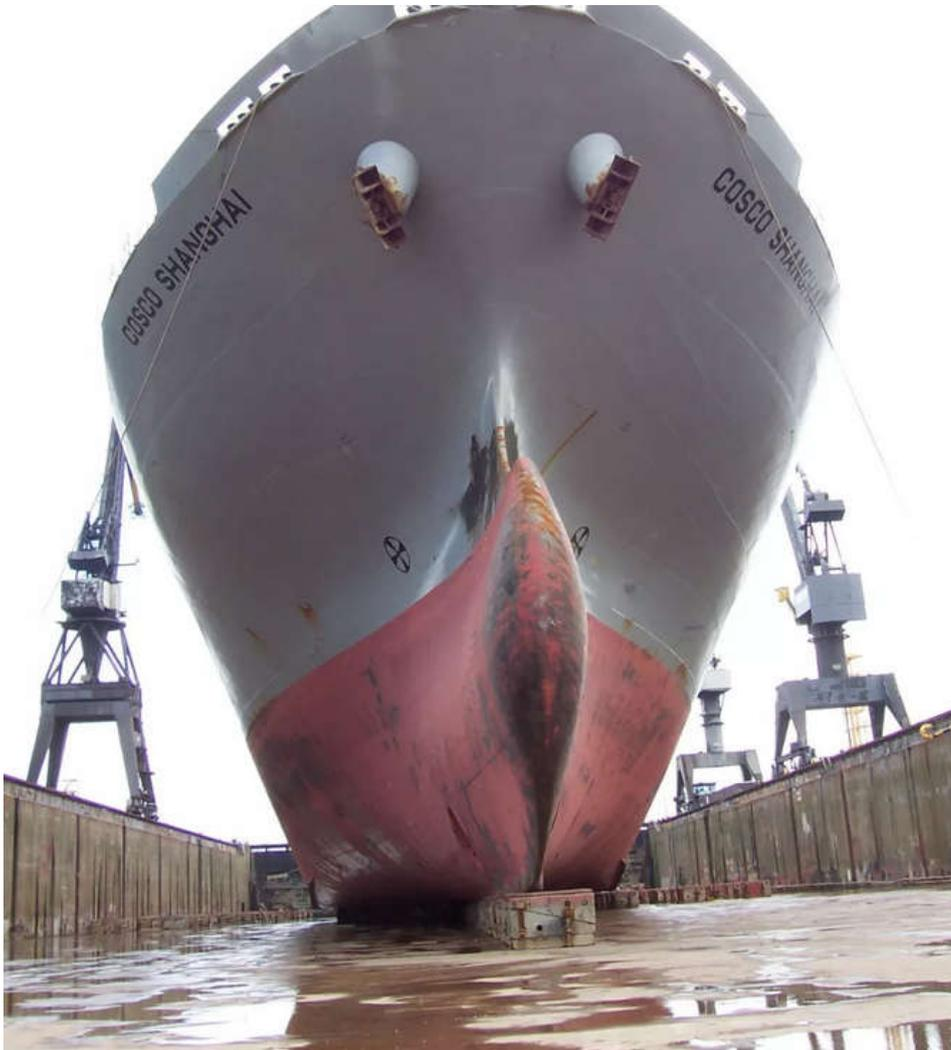
一般船级社在完成船级坞检以后，也认为船底外部检查同时完成。完成船底外部检查后，验船师应在货船构造安全证书中船底外部检查签署栏中进行签署以保持该证书有效。同样，完成船级坞检后，验船师也应在入级证书中相关签署栏中进行签署以保持入级证书有效。
